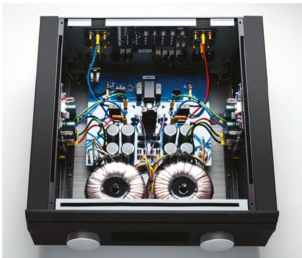
La carte supérieure contenant les nuvistors a été ôtée, laissant voir l'alimentation entièrement double mono. Des condensateurs de filtrage sont placés au plus près des transistors de puissance, et toutes les cartes sont reliées par des connecteurs.
